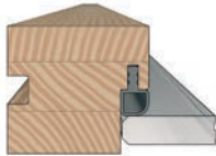
6. Stable door frame.
